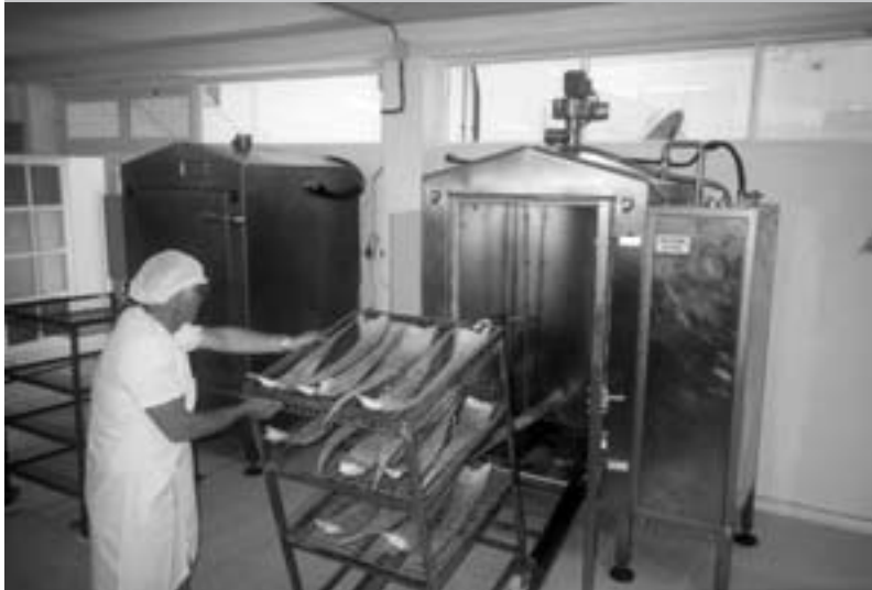
Figura 2.10 - La delicata fase del lavaggio con i sali specifici.
